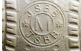
JSBB刻印マーク(M号) J号は「J」の刻印になります
